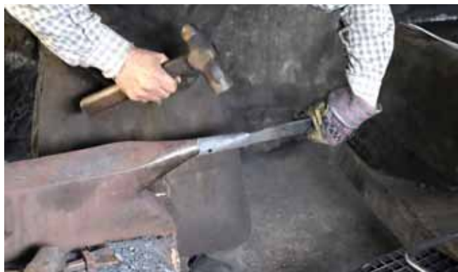
Repasando a mangueira co martelo
