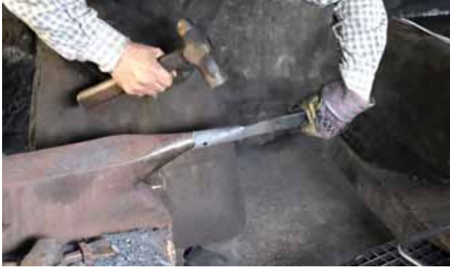
Repasando a mangueira co martelo
