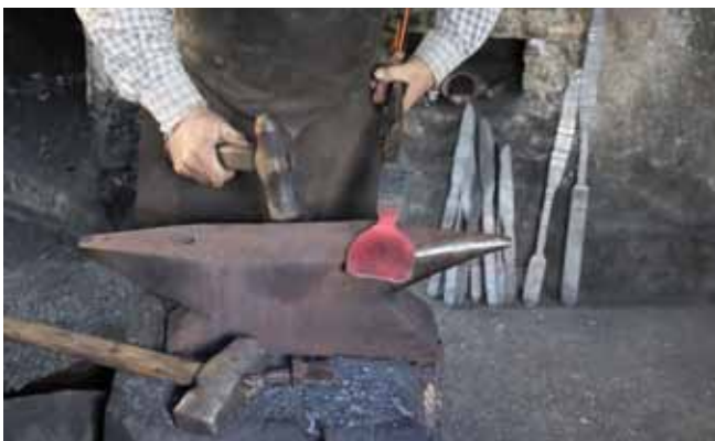
Moldeando o enmangue ou mangueira co martelo de bola.
