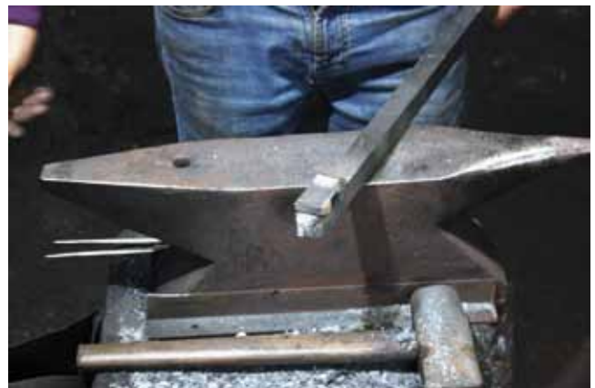
Vergallón de ferro con aceiro antes de ser calzado
